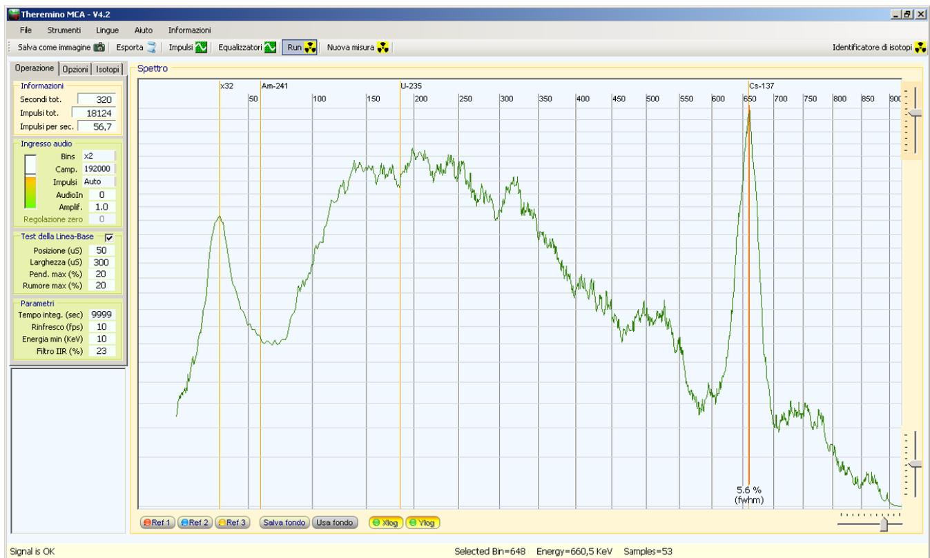
Esempio realizzato con questo set , il campione è una valvola Spark Gap contenente tracce di Cs137
