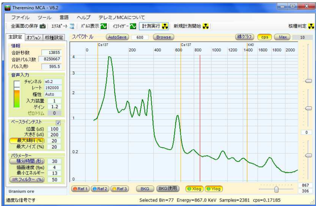
Theremino MCA 6.2 : Sovtube CsI2.5インチ測定機で、ウラン原石を測定したスペクトルの例
